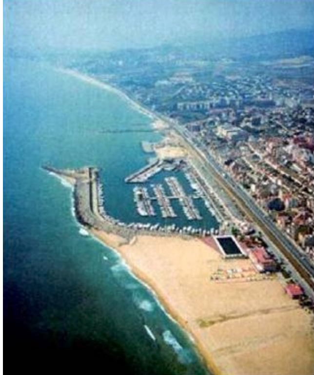
Imagen 3: efectos en el transporte litoral de un puerto deportivo (fuente: Ministerio de Medio Ambiente).
